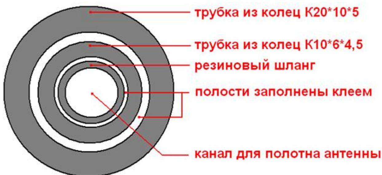
Рис.4. Схема поперечного разреза муфты
