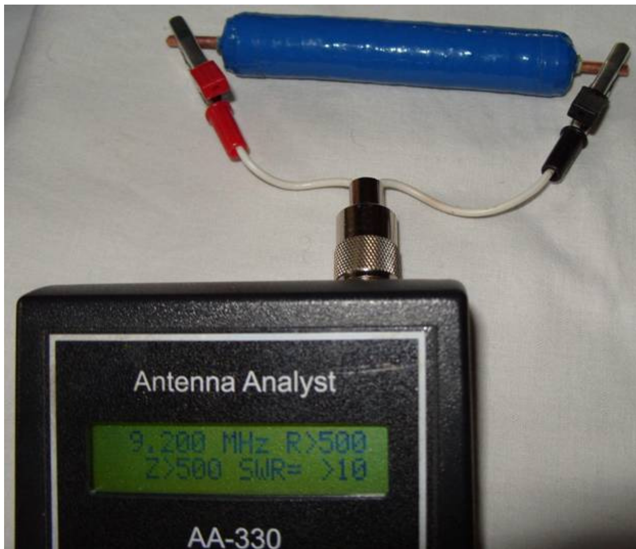
Рис.2. Муфта из НЧ ферритовых колец - высокочастотный изолятор
